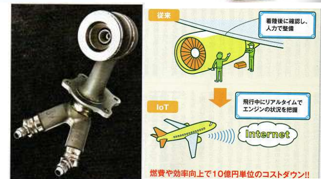
図70-15 IICの活用例(左 - 3Dプリンタ製造のガスタービン燃料ノズル、右 - 航空エンジンの飛行中のモニタ)
