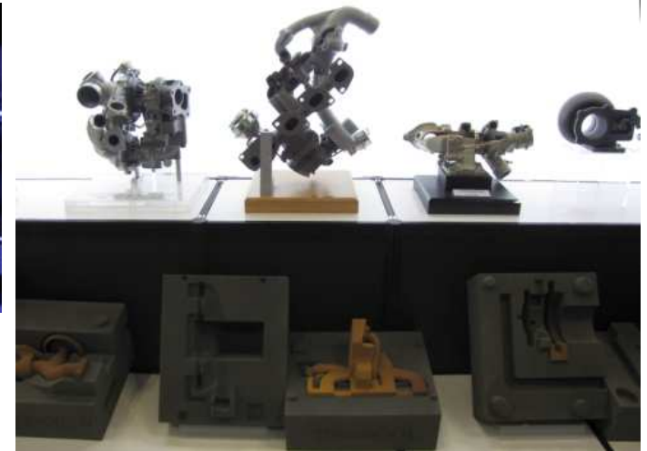
大手4社のターボチャージャの試作サンプル。下に並んでいるのは、3Dプリンタで製造した砂型(コイワイ)
