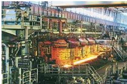
図61-35 千葉No.3全連続熱間圧延機 (JFEスチール)
