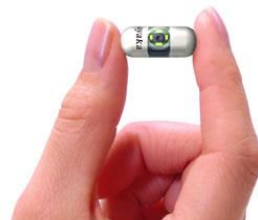
図58-19 LED組み込みのカプセル型内視鏡 (アールエフ社 Sayaka)
