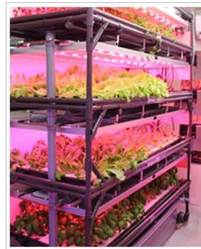
図58-18 LED光源植物工場用栽培ユニット (キーストーンテクノロジー)
