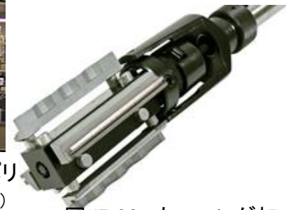
図57-23 ホーニング加工機の超砥粒ダイヤモンド工具 (Wikipedia)
