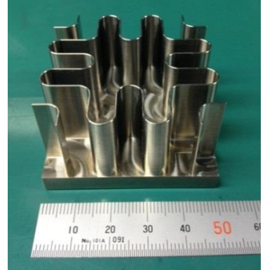
図57-1 チタンの薄肉加工 (厚さ 0.5t \pm 0.01 ) (相埼電機製作所)
