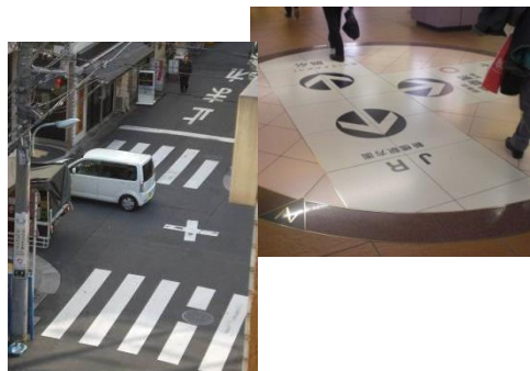
図56-3 公共通路床面への案内塗装
