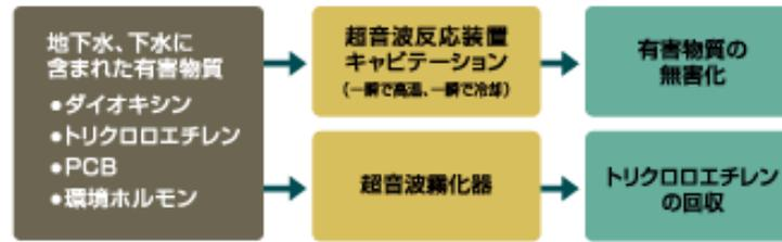
図54-22 超音波による有害物質の分解、分離 ⑥
