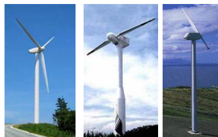
図52-12 1,2,3-枚羽根のプロペラ風車 (MHI)
