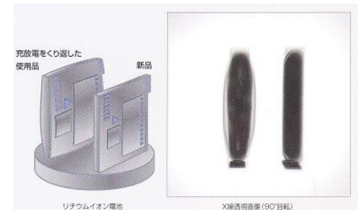
図46-30 充放電繰り返しによる膨潤 (島津製作所)
