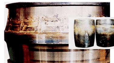
図38-30 損傷各種 (上から フレーキング、かじり、割れ、磨耗、焼付き) (NSK)
