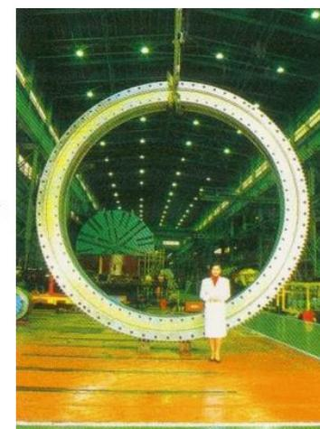
図38-6 トンネル掘削機の大形軸受 ⑦
