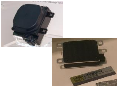
図34-26 100~200m先の障害物を検知するミリ波レーダ (三菱電機/上と日立/下)
