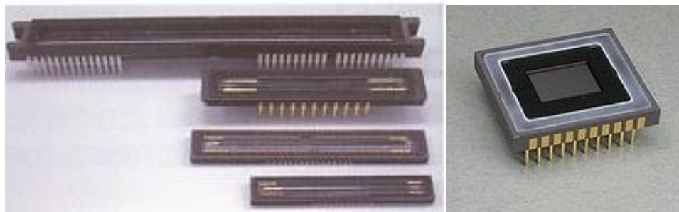
図34-8 CCDイメージセンサー1次元(左)と2次元(右) ③
