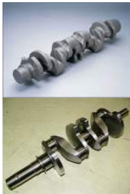
図24-10 クランクシャフト鍛造素材と加工品
