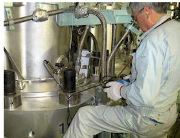
図17-24b インジェクタ線図採取
