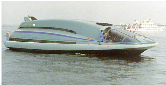
図17-1 超電導電磁推進実験船「ヤマト」
