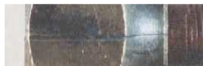
図11-18a 快削黄銅棒(C3604)における応力腐食割れの例
