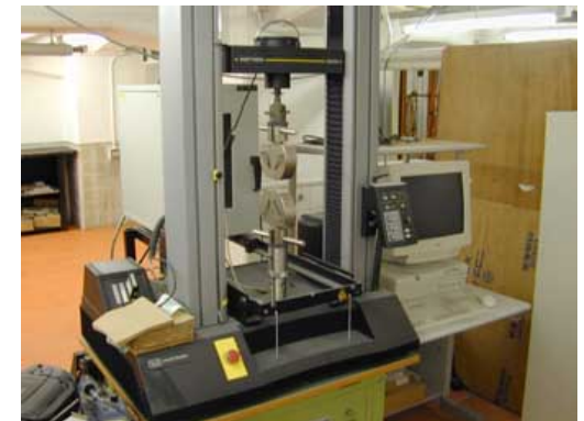
図11-5 2t引張り試験機 (東大)
