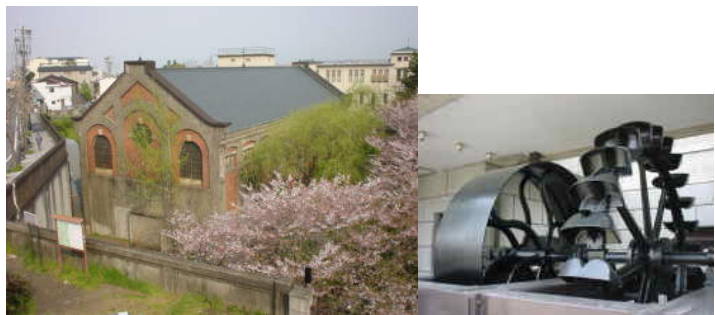
図10-2 蹴上発電所とペルトン水車
